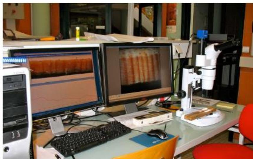
Banc de mesure de largeurs de cernes par analyse d'image (photo D Bert)
